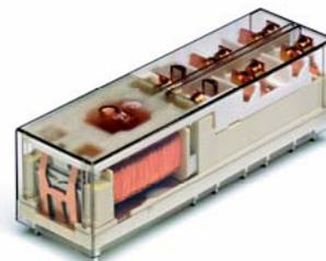
Abb.1-10 TYCO - Relais mit Klappanker
