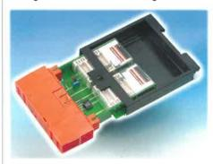
sprechenden Gehäuses die Realisierung eines 22,5 mm breiten Not-Aus-Moduls – mit derzeit auf dem Markt einmaligen vier sicherheitsgerichteten Schließern und zwangsgeführten Kontakten. Das Gehäuse erlaubt es, die Kontakte über Leiterbahnen direkt an die Anschlußklemmen zu führen und bietet viel Bestückungsfläche, vor allem auf der Leiterplattenrückseite.
