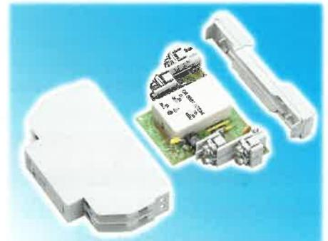
Abhilfe schafft nun das Sicherheitsrelais OA 5667 (37 x 25 x 10,8 mm) von **DOLD**. Flachbauend ermöglicht es die Realisierung derartiger Schaltungen mit nur einer Leiterplatte bei 17,5 mm Breite. Es entspricht den Sicherheitsregeln der Berufsgenossenschaft ZH1/457, der DIN EN 50205 und allen relevanten VDE-Vorschriften. Neben der sicheren Trennung zwischen Spule und Kontakten bietet es auch eine sichere Trennung zwischen den zwangsgeführten Kontakten.
