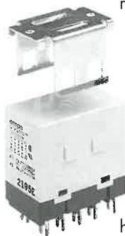
24VDC geliefert werden. Der Kontaktabstand von 3mm ermöglicht eine Netztrennung nach EN 60950. Dies wird zur sicheren Trennung vom Versorgungsstromkreis sowie als Mindestluftstrecke zur Isolierung von Primärstromkreisen und zwischen Primär- und Sekundärstromkreis nach DIN EN 60950 (VDE 0805) gefordert. Die Luft- und Kriechstrecken betragen > 8 mm. Der max. Schaltstrom von 24A und die max. Schaltspannung von 400VAC ermöglichen 3-phasige Motorlasten von 3,7 kW nach AC-3.
