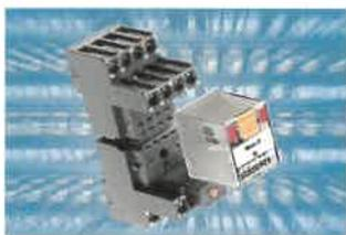
Angeboten wird es mit 2, 3 oder 4 Wechslern für Schaltströme von jeweils 12, 10 und 6A, bei einer Bauhöhe von nur mehr 29mm. In der Ausführung mit 2 und 3 Wechslern erfüllt es die Anforderungen der Isolationsklasse C250.
