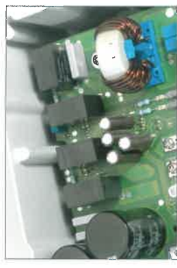
Abb. 3: PCFN Solar Relais mit 1,5 mm Kontaktabstand
